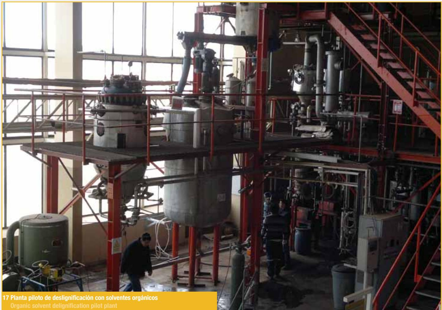
17 Planta piloto de deslignificación con solventes orgánicos
